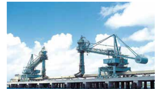
バケットエレベータ式連続アンローダ 取扱物：石炭など
