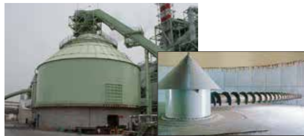
旋回スクリー方式サイロ貯蔵システム 取扱物：木質チップ、木質ペレット、建廃など
