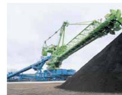
スタックリクレーマ 取扱物：石炭、石灰石、木質チップなど
