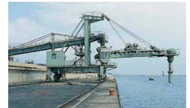
シップローダ 取扱物：石炭、石灰石、石膏、木質チップなど
