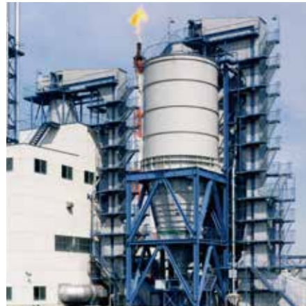
垂直ベルトコンベヤ 取扱物：石炭、木質チップなど
