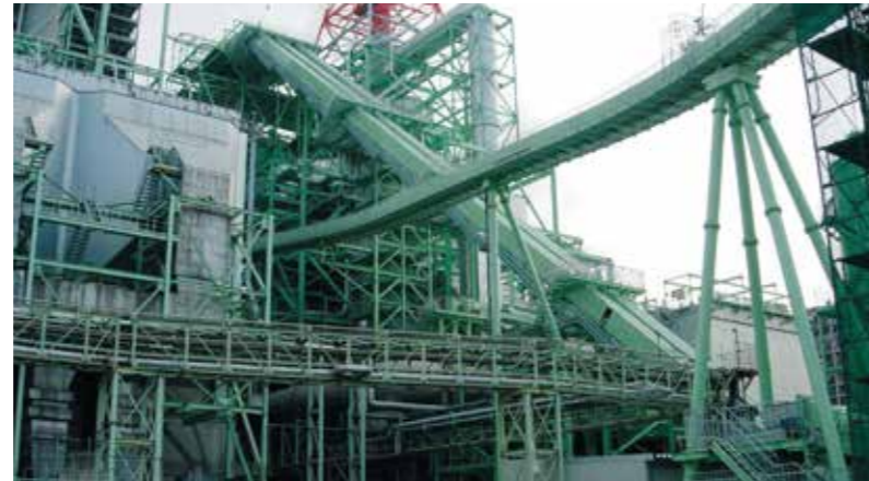
急傾斜ベルトコンベヤ／パイプベルトコンベヤ 取扱物：石炭、木質チップなど
